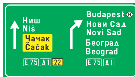
III-211 Preputokazna tabla za razdvajanje dva autoputa
