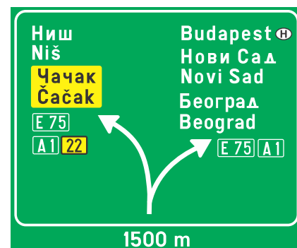
III-209 Preputokazna tabla za razdvajanje dva autoputa
