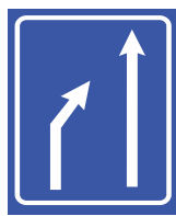
III-79.1 Znak za zatvaranje saobraćajne trake
