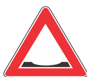
I-9 Neravan kolovoz (ulegnuće)
