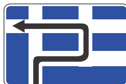
III-10 Smer kretanja vozila koje namerava da skrene u levo na raskrsnici na kojoj je skretanje u levo zabranjeno
