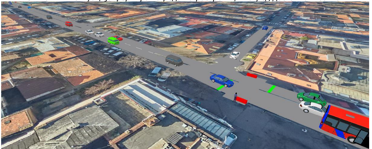
Слика 7.25. Ситуација формирања реда иза доставног возила и маневра обилажења
