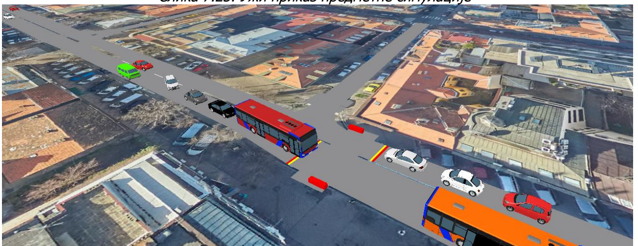
Слика 7.24. Ситуација формирања реда на раскрсници испред доставног возила
